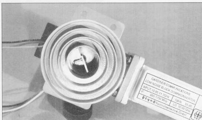
Close-up van het diëlectrisch schotje in het 'keelgat' van de feedhoorn
